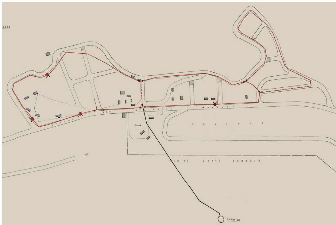
Fig. 14: Progetto esecutivo rete di distribuzione per l'acquedotto di Villa Racise (ACS, Ministero Agricoltura e Foreste, DG Bonifica e Colonizzazione, OVS (1951-1955), b.66, fasc.47).
