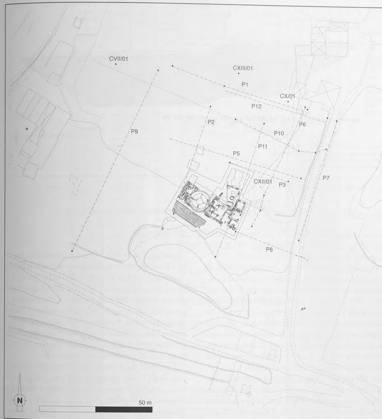
Fig. 3. Cuma. Settore A. Pianta con il posizionamento dei profili geoelettrici e dei carotaggi.
