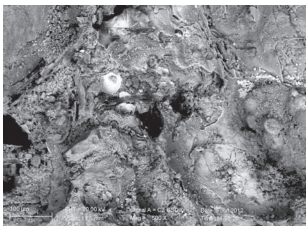
Fig. 16 - Micrografia SEM del frammento di crogiolo n. 161-B: micro-gocciola di rame.
