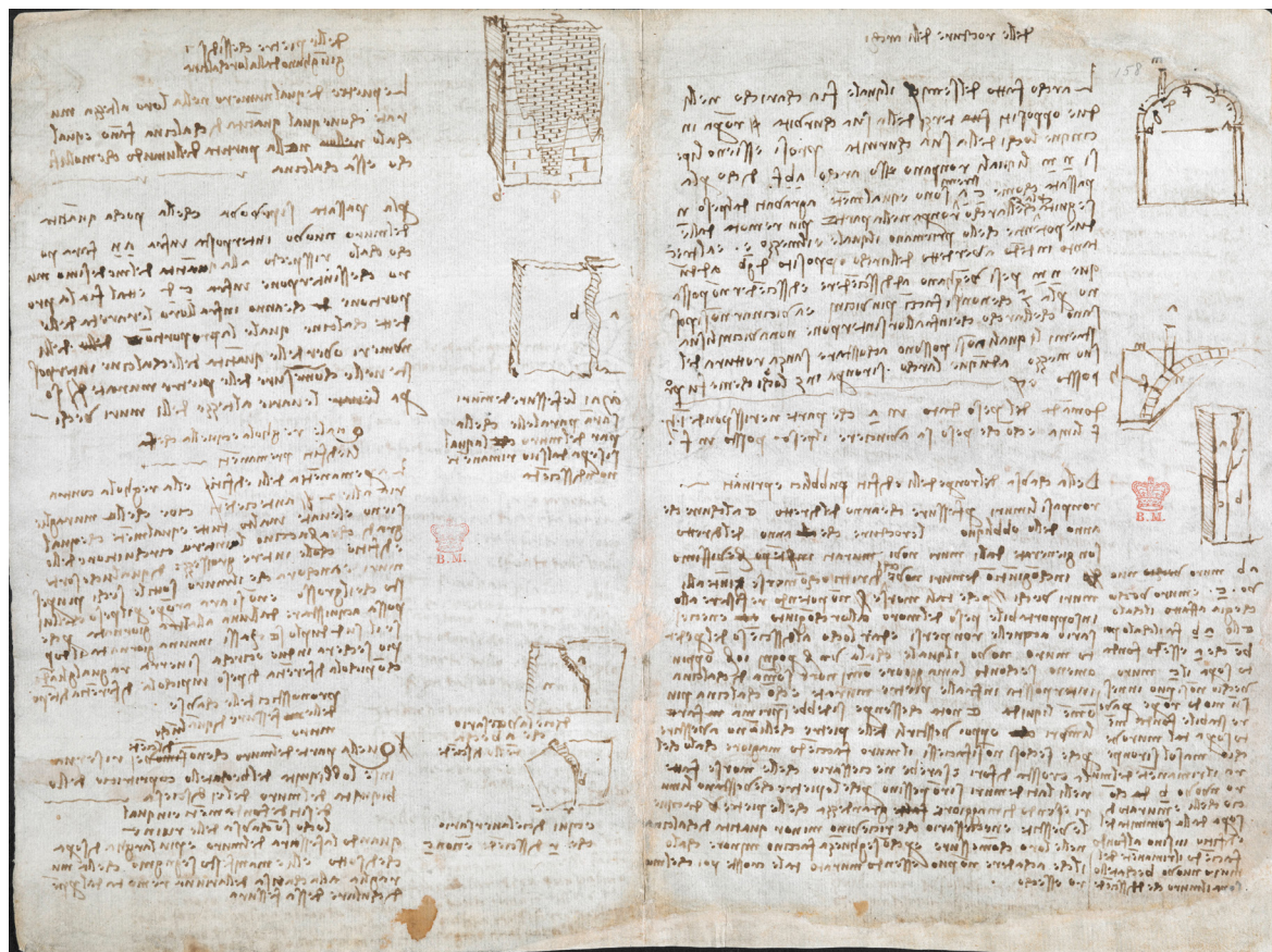
Fig. 7 – Leonardo, Disegni vinciani sul funzionamento statico delle strutture, sui carichi verticali della muratura, sui dissesti fondazionali, specialmente dovuti all’umidità. Londra, British Library, Codice Arundel, ff. 157v-158r, ca. 1506-1508. (Da Fac-simile dell’Edizione Nazionale dei Disegni e dei Manoscritti di Leonardo)
