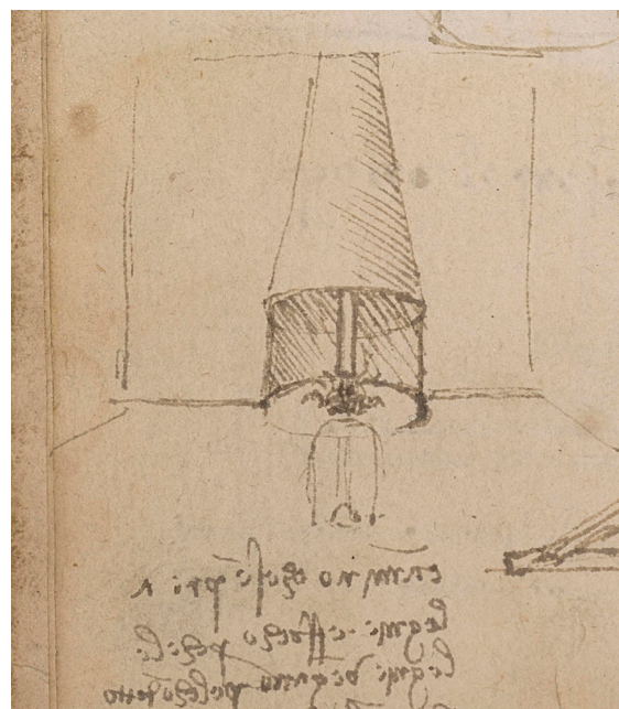
Fig. 8 - Leonardo, Camino con condotto a doppio uso per l'alimentazione della legna e la ventilazione del fumo. Parigi, Institut de France, Ms. B, c. 23v (dettaglio). (Da Fac-simile dell'Edizione Nazionale dei Disegni e dei Manoscritti di Leonardo)
