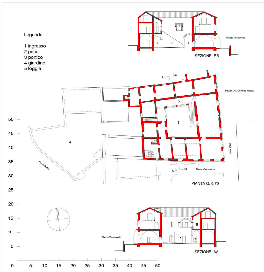
Fig. 11: Grafici in sezione orizzontale e verticale di palazzo Petrucci (rilievo ed elaborazioni grafiche degli autori).
