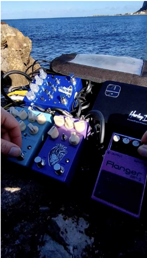
7. Set up per improvvisazione sonora con il mare – routing 1: Boss BF-2 ( Flanger ), AC Noises Ama, Respira, Ricorda (Riverbero/ bit crusher , tremolo, riverbero granulare), power bank Harley Benton
