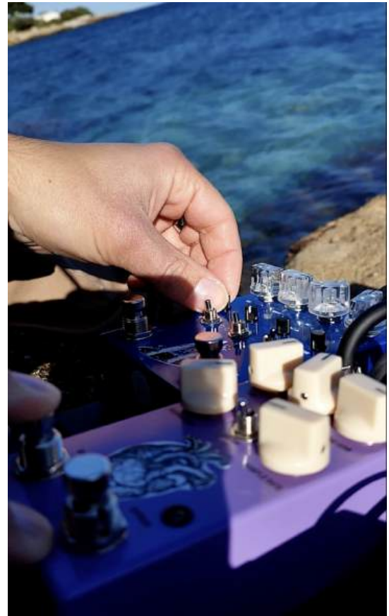
10. Set up per improvvisazione sonora con il mare - routing 3: AC Noises Ama e Ricorda (Riverbero/ bit crusher , riverbero granulare), power bank Harley Benton
